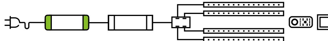
Netzstecker - Konverter - Steuerung - Verteiler - mehrere LED Module/Leuchten parallel - Fernbedienung/Wandschalter
