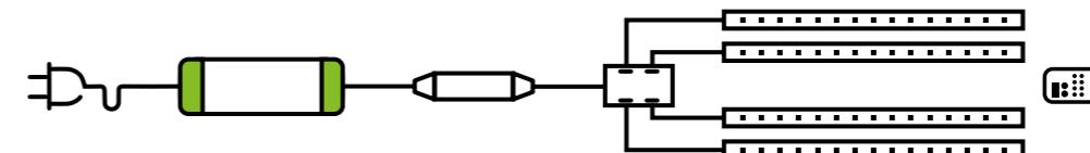
Netzstecker - Konverter - Steuerung - Verteiler - mehrere LED Module/Leuchten parallel - Fernbedienung
