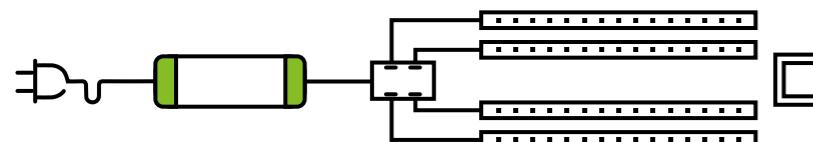
Netzstecker - Konverter - Verteiler - mehrere LED Module/Leuchten parallel - Wandschalter
